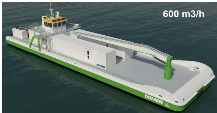
6 pav. Baržos su balastinio vandens valdymo sistema iliustracija.
